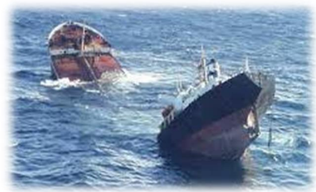
「プレステージ号」折損事故(2002年11月)
