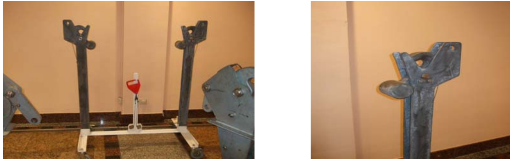
写真3 オフロード離脱フックの一例
