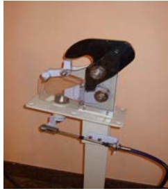
写真4 コーン型にロックピースを加えた機構
