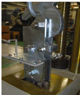
写真 8 繰り返し荷重試験においてカムレバーに錘を付けた状態
