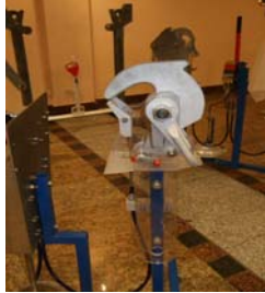
写真5 カム型にロックピースを加えた機構
